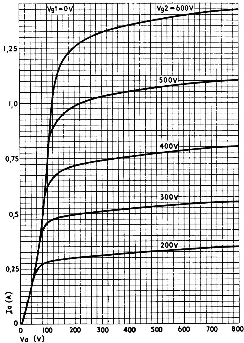
**SCREEN CURRENT – ANODE VOLTAGE. ZERO GRID VOLTAGE WITH SCREEN VOLTAGE AS PARAMETER**
