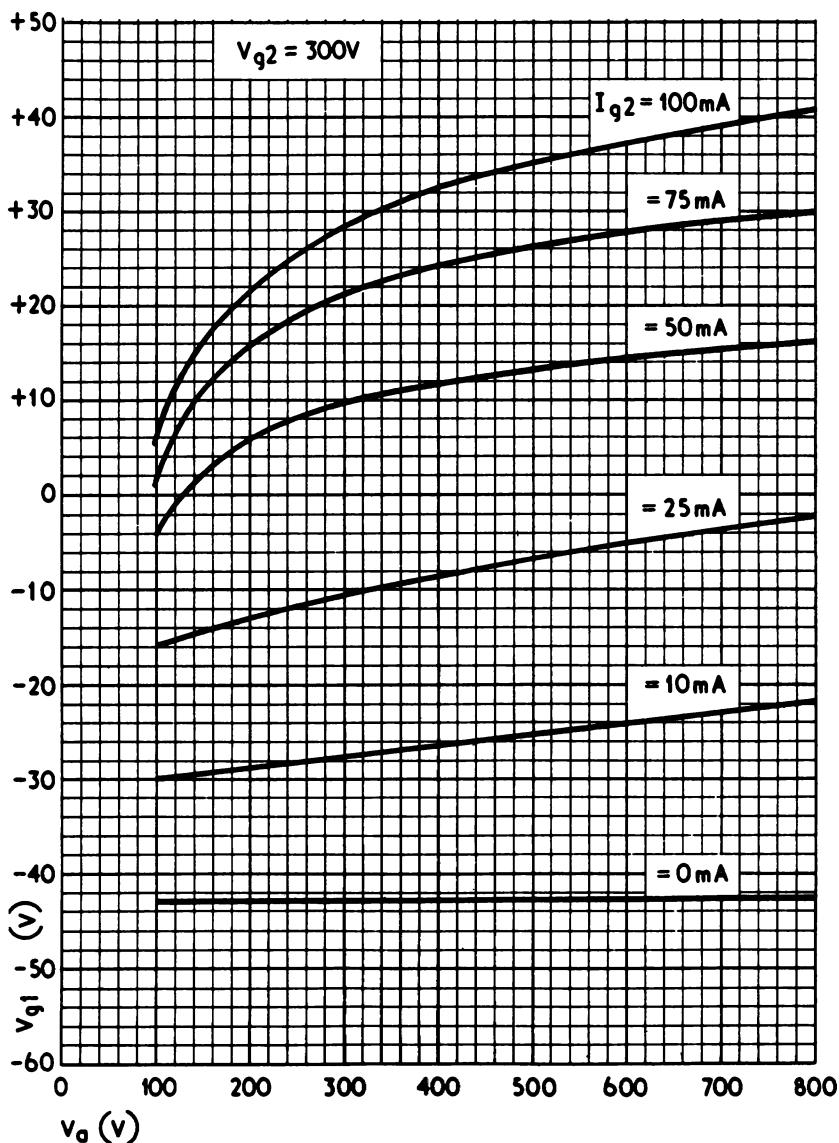
**CONSTANT GRID CURRENT CURVES WITH SCREEN VOLTAGE AT
