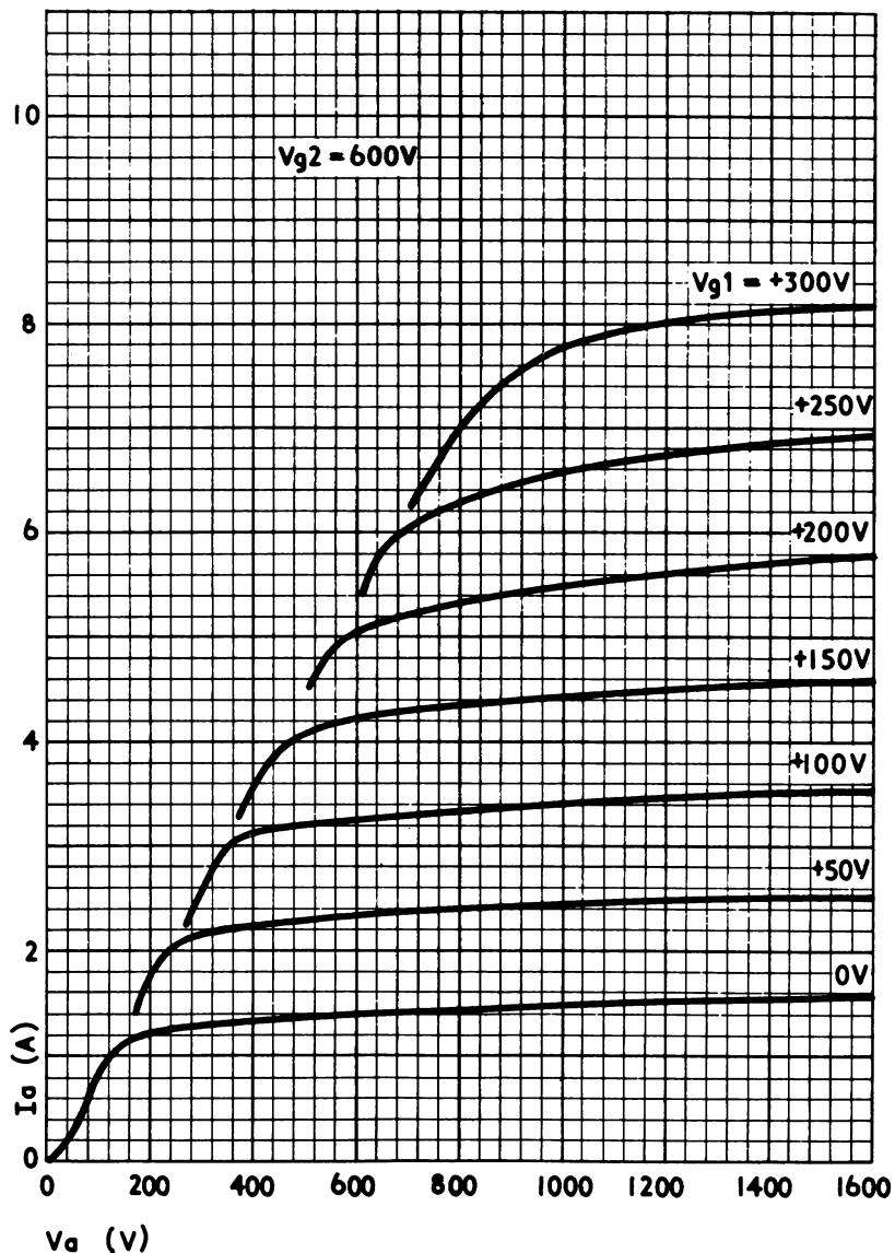
**SCREEN CURRENT – ANODE VOLTAGE. SCREEN VOLTAGE AT 600V
