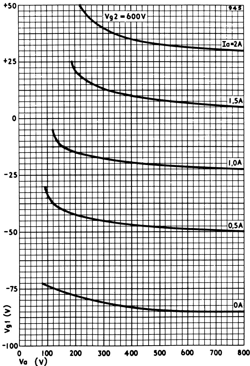
**CONSTANT SCREEN CURRENT CURVES. SCREEN VOLTAGE AT 600V**
