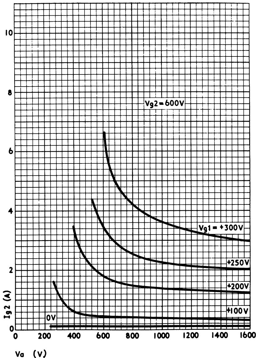
**GRID CURRENT – ANODE VOLTAGE. SCREEN VOLTAGE AT 600V
