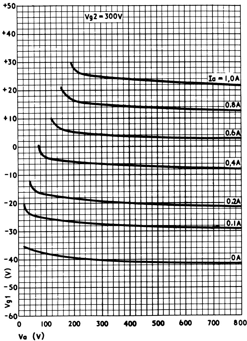
**CONSTANT SCREEN CURRENT CURVES WITH SCREEN VOLTAGE AT 300V**
