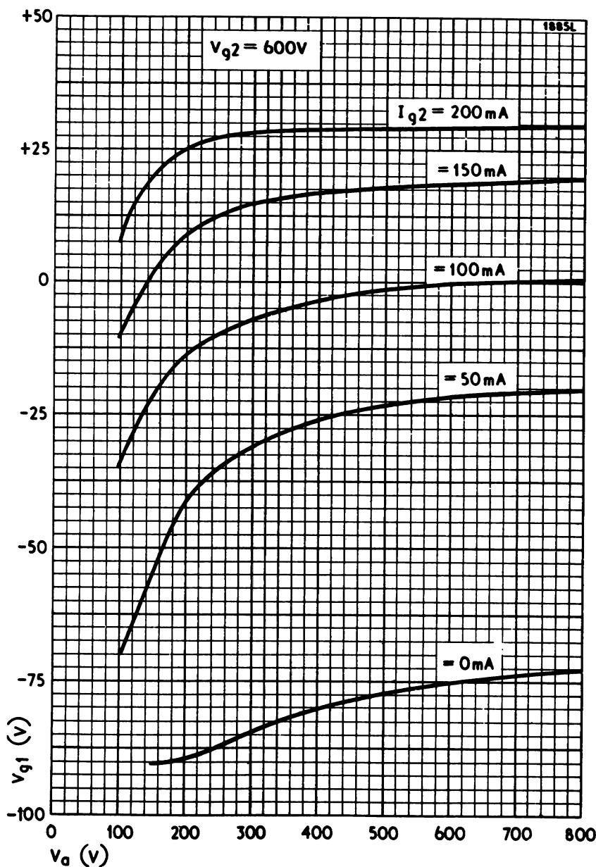
**CONSTANT GRID CURRENT CURVES. SCREEN VOLTAGE AT 600V**
