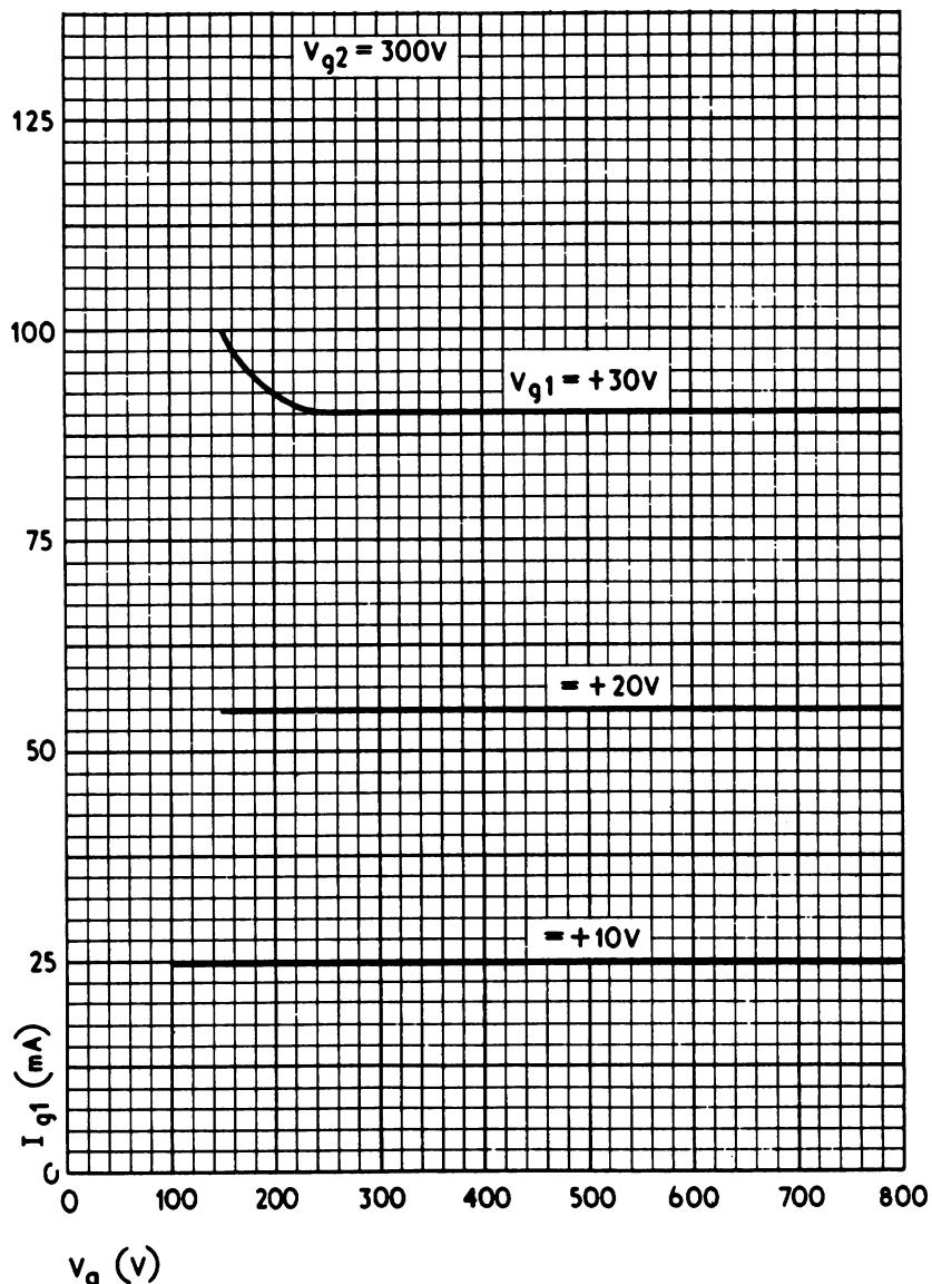
**ANODE CURRENT – ANODE VOLTAGE. ZERO GRID VOLTAGE WITH SCREEN VOLTAGE AS PARAMETER**
