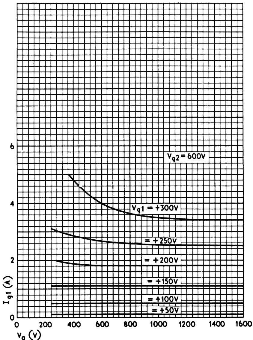
**CONSTANT ANODE CURRENT CURVES. SCREEN VOLTAGE AT 600V**
