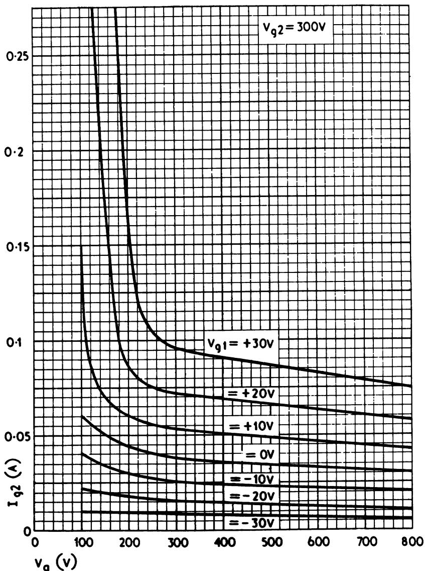
**GRID CURRENT – ANODE VOLTAGE. SCREEN VOLTAGE AT 300V
