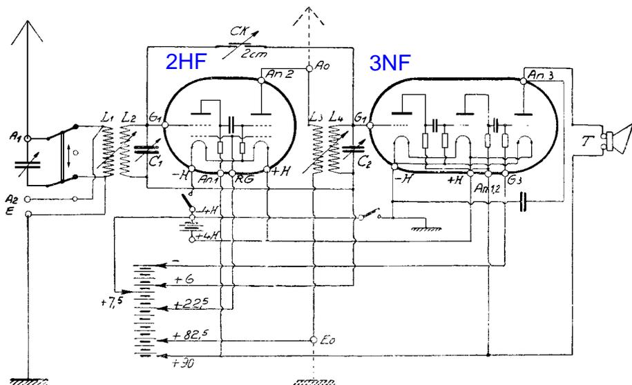
**NB.** Die Erdungsbezeichnung an der — H Leitung der Röhre 3 NF bedeutet metallischer Belag der Frontplatte des Apparatkastens, nicht Erde.
